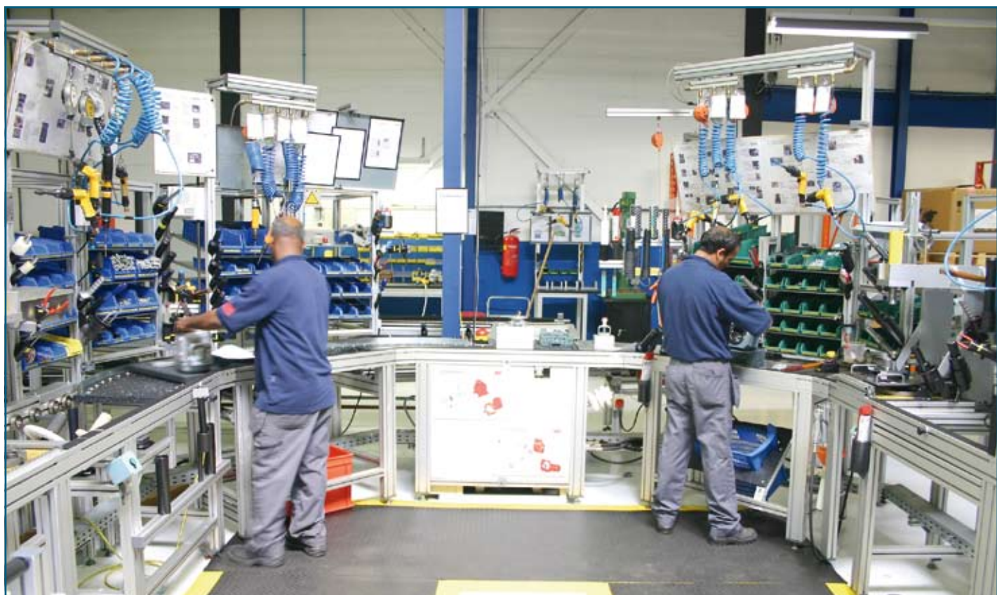
Bij Vector zijn 10 u-vormige eilanden gemaakt waar we alle aandrijvingen kunnen worden geassembleerd.
