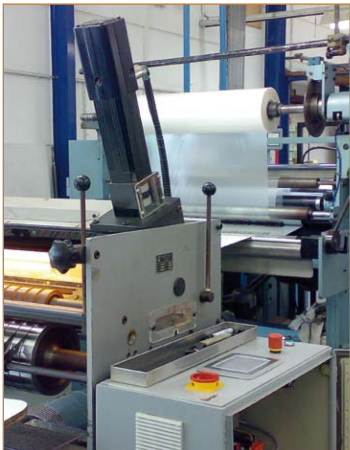
Afbeelding 3. Met de SEW synchroommotor en bijbehorende besturing is een compacte oplossing gevonden om de gewenste snelheden en versnellingen te realiseren. Bron: WhiteCube
