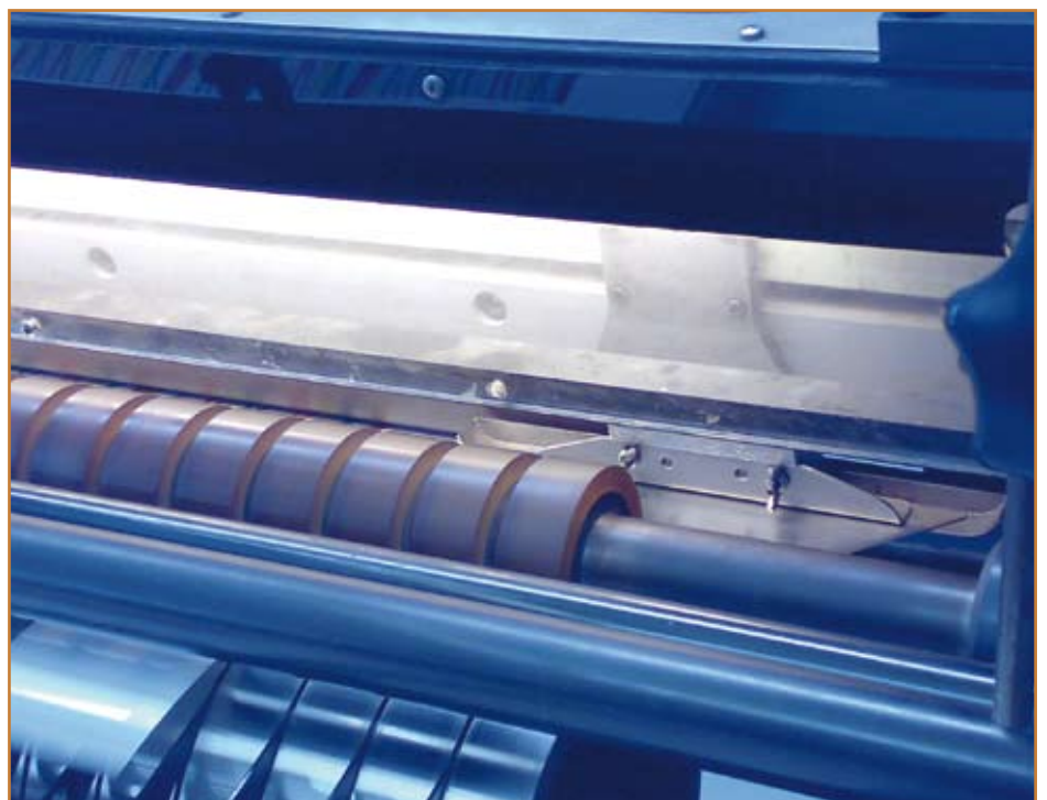
Afbeelding 2. Het mes beweegt zich in een tijd van 0,1 s over een afstand van 1000 mm om de folie door te snijden. Bron: WhiteCube
