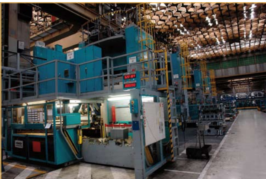
Persstraat bij NedCar in Born die in 2009 is voorzien van nieuwe aandrijvingen en een veiligheidsbesturing voor het transportsysteem.
