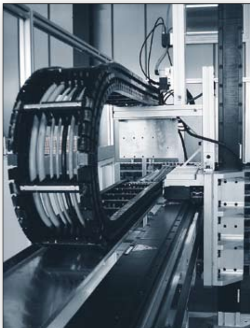
Afbeelding 3. Applicatie met lineaire servomotor.
