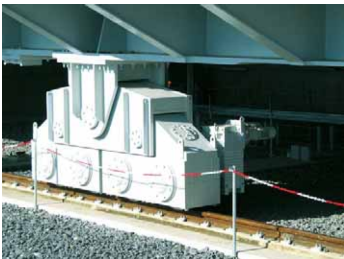
De bogie is gebaseerd op het ontwerp van de rijaandrijving van grote havenkranen
