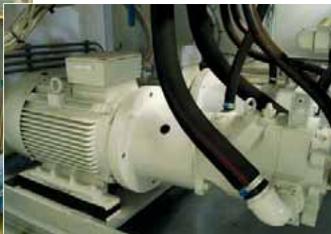
Onder: De twee hydraulische pompen leveren elk een maximale druk van 350 bar en een opbrengst van 95 \text{ dm}^3/\text{min}
