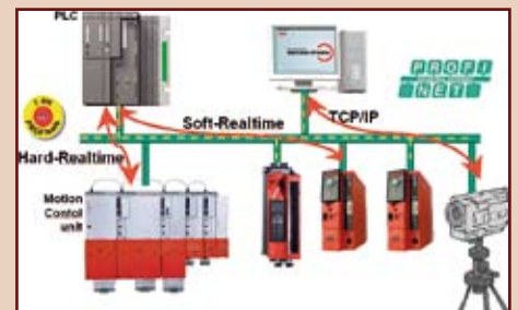
Afbeelding 2. Met Profinet is het mogelijk zowel de data voor relatief trage communicatie als de data naar tijdkritische processen te verzenden. In 2007 wordt het ook mogelijk data voor veiligheidsfuncties via Profisafe over hetzelfde bussysteem te versturen.
