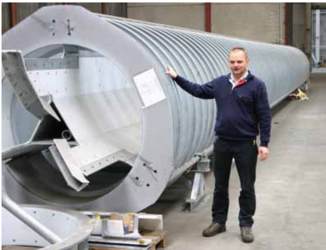
Afb. 1 Sander Brouwer (Breman Machinery) bij een 26 meter lange schijvenkolom
